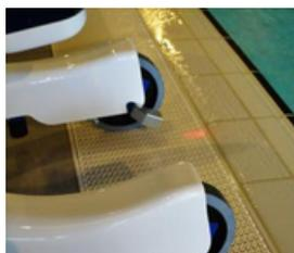
Système de détection infrarouge du bord du bassin avec alarme sonore (option)
