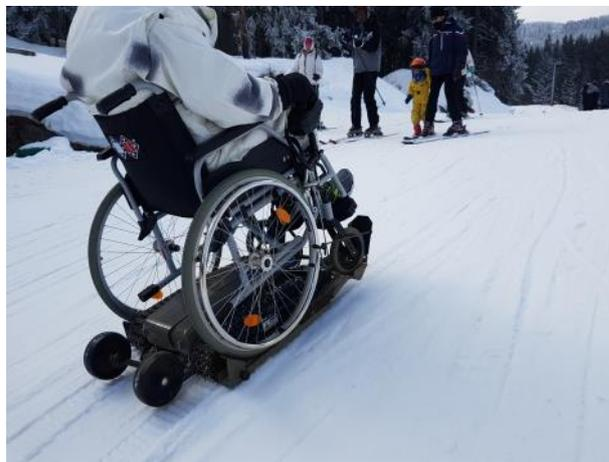
Le FT1 peut être monté et démonté sans assistance et est livré avec un joystick. Il est réglable pour des largeurs de roues comprises entre 50 et 58 cm, ce qui permet d'adapter la majorité des fauteuils roulants manuels.
