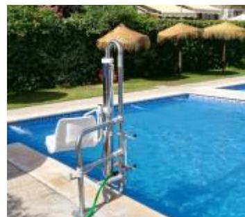
L'élévateur NEREE B2 se monte aussi aisément qu'il se démonte, sans intervention nécessaire dans l'eau. Il fonctionne grâce au circuit d'eau potable du bâtiment, avec une pression entre 3.5 et 5.5 bars (selon la capacité de levage souhaitée).
