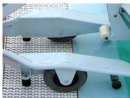
Tampons en caoutchouc automatiques escamotables, entre les roues avant et arrière qui évitent à la machine de basculer
